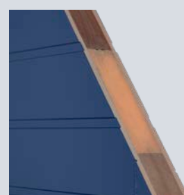
DETAIL ACHTERDEUR Isolerende kern
