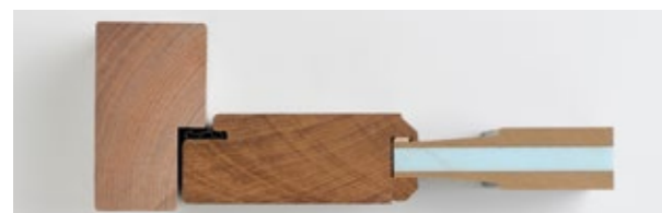
Doorsnede geïsoleerde deur 54 mm.
